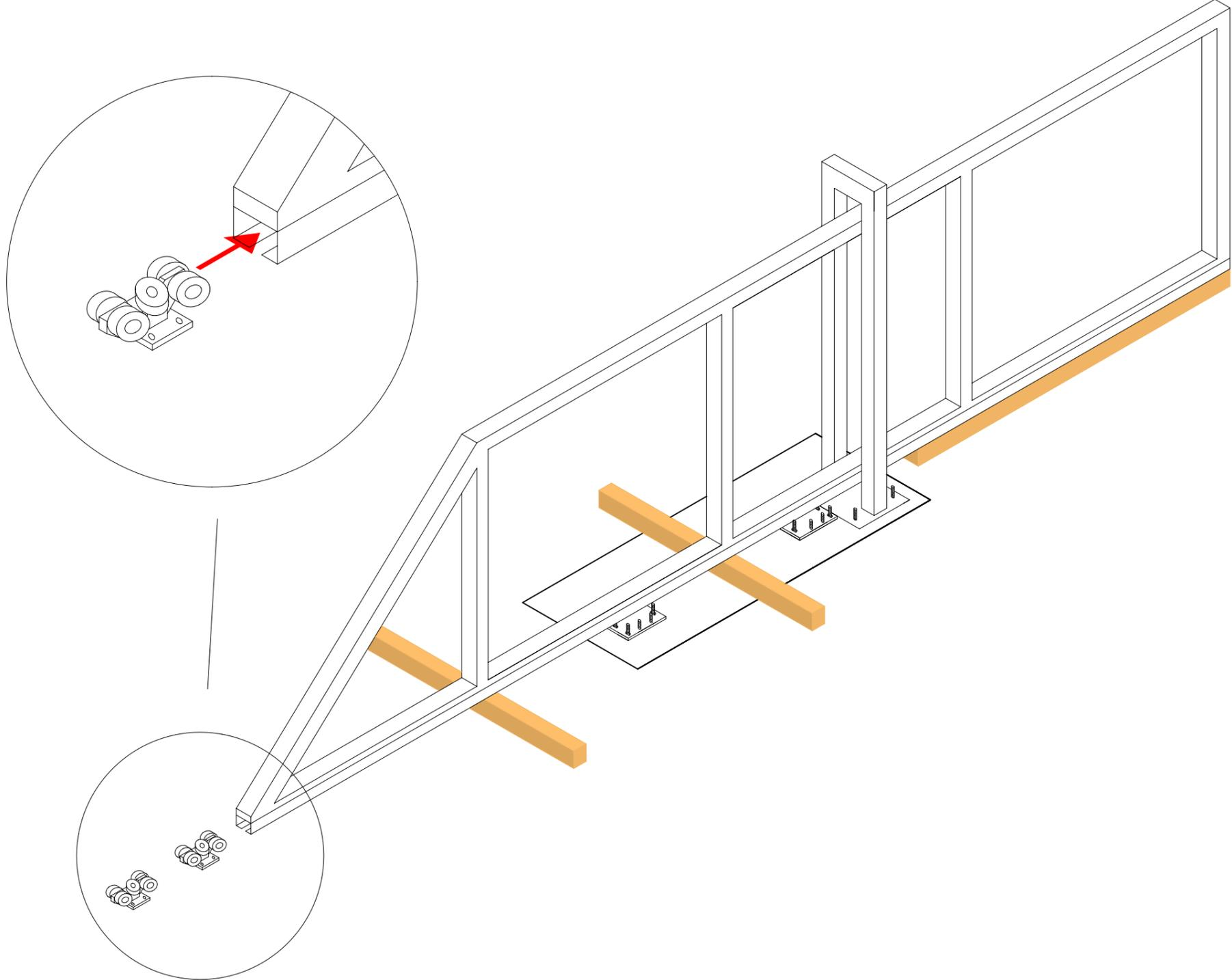
Schritt 9: Oberteile der Rollböcke soweit vorziehen, dass sie sich über den bereits befestigten Unterteilen befinden. Dann den oberen Teil wieder an dem unteren befestigen.
