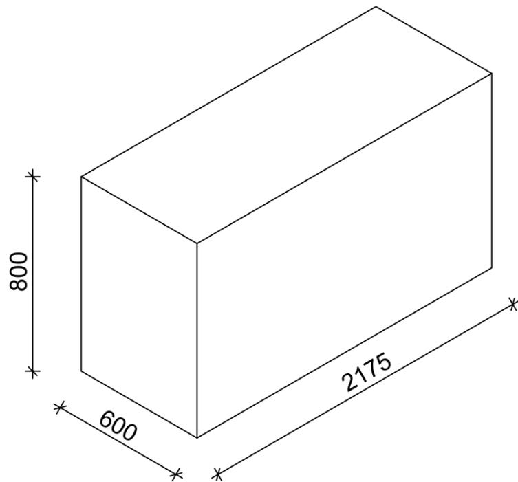
Bei den Maßen für das Fundament handelt es sich um Mindestmaße für eine gute Bodenbeschaffenheit. Es kann sein, dass Sie aufgrund schlechterer Bodenqualität ein größeres Fundament benötigen. Wenn Sie sich in einer frostreichen Region befinden, muss das Fundament tiefer als 800mm ausgeführt werden. Um Frostsicherheit auf tragfähigem Untergrund zu gewährleisten, müssen Sie einen Bodengutachter einschalten.
