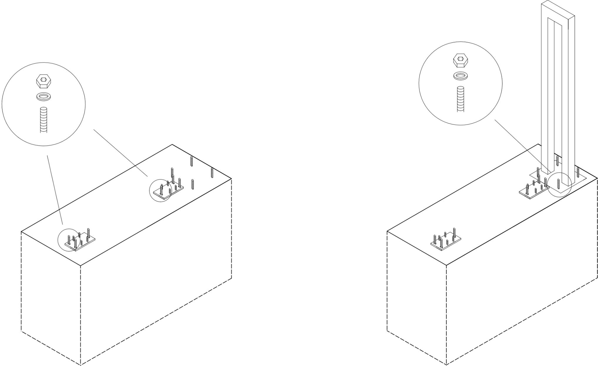
Schritt 7: Torflügel relativ mittig durch den Durchgangspfosten platzieren
