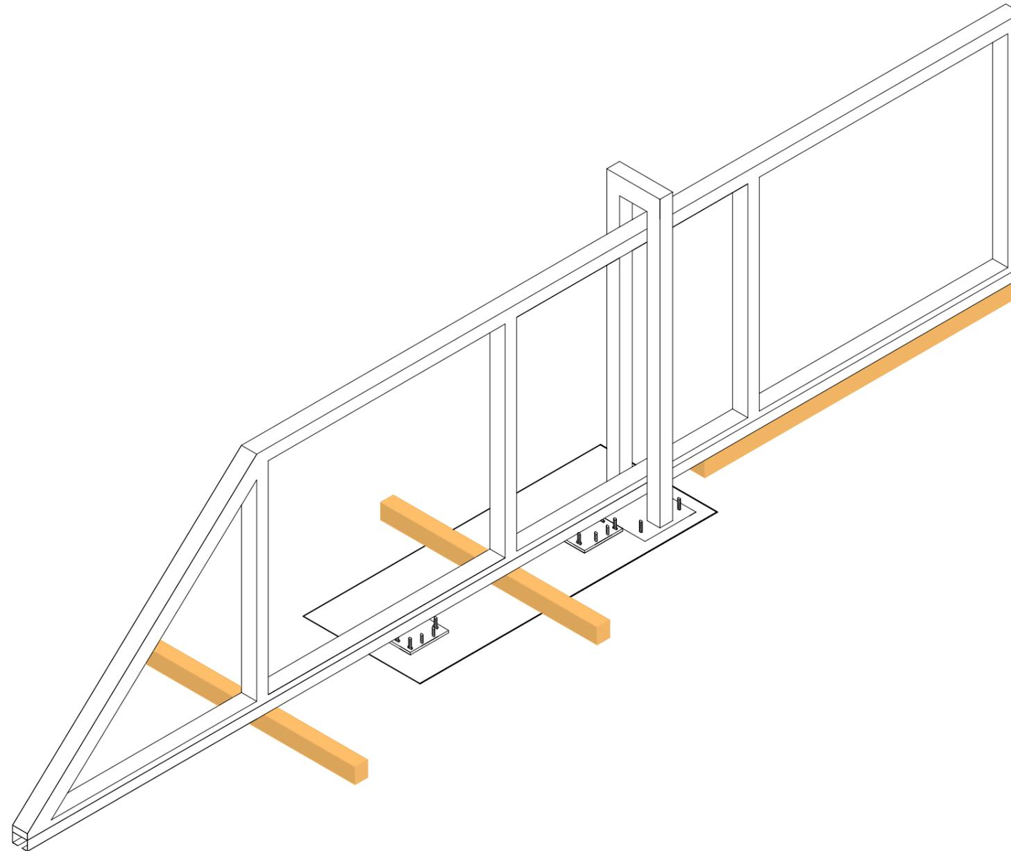
Schritt 8: Oberteile der beiden Rollböcke in das Tor einschieben
